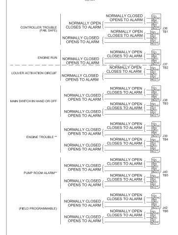
ALL WIRING BETWEEN THE CONTROLLER AND DIESEL ENGINE SHALL BE STRANDED (NFPA20)
