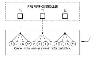
12 LEADS MOTOR FOR DUAL VOLTAGE MOTOR OPERATING ON THE LOWER OF THE TWO VOLTAGES
