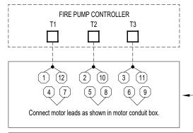
12 LEADS MOTOR FOR DUAL VOLTAGE MOTOR OPERATING ON THE HIGHER OF THE TWO VOLTAGES
