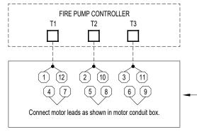
12 LEADS MOTOR FOR DUAL VOLTAGE MOTOR OPERATING ON THE HIGHER OF THE TWO VOLTAGES
